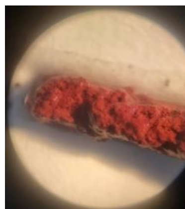
Fig.4 – Depozit pulverulent de cupru, mărire 20x
