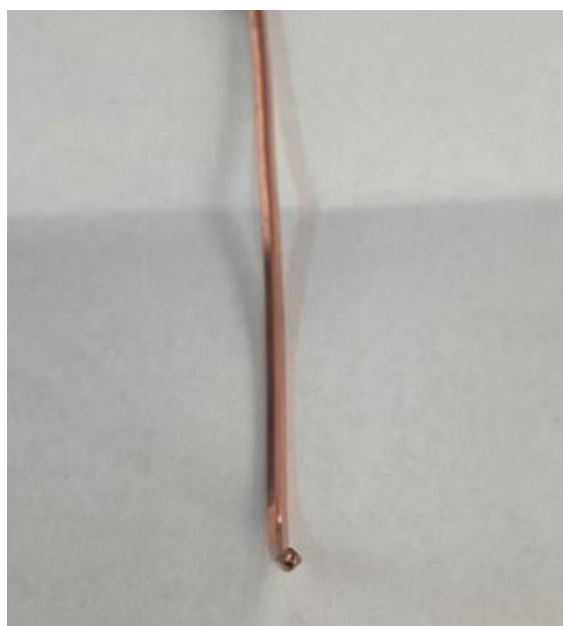
Figura 3.5. Semifabricatul din cupru dupa laminarea prin calibrul pătrat.
