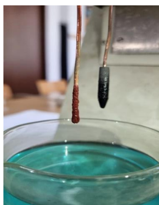
Figura 3 – Anod de grafit și catod cu depozit de pulbere de cupru
