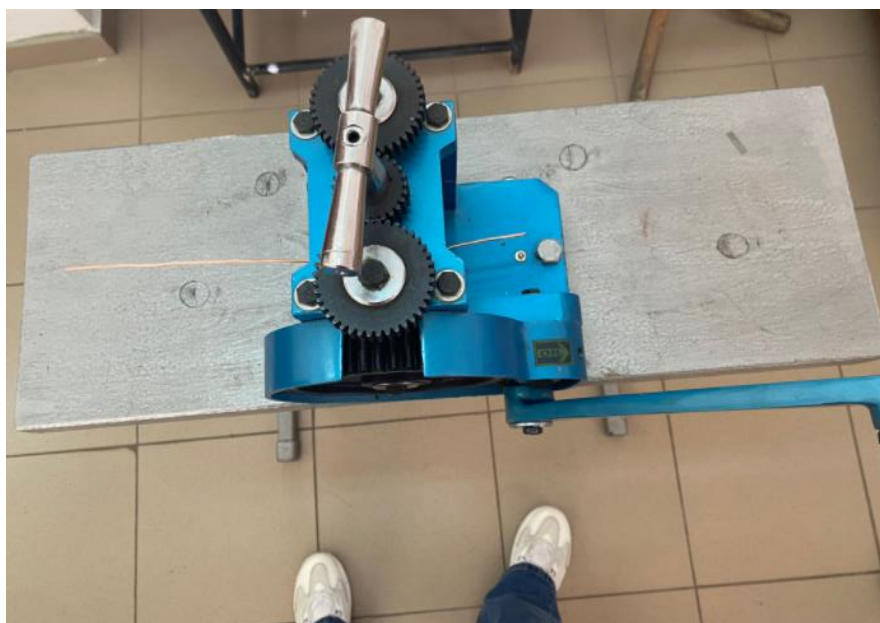
Figura 3.6. Laminarea semifabricatului din cupru prin calibrul dreptunghi.
