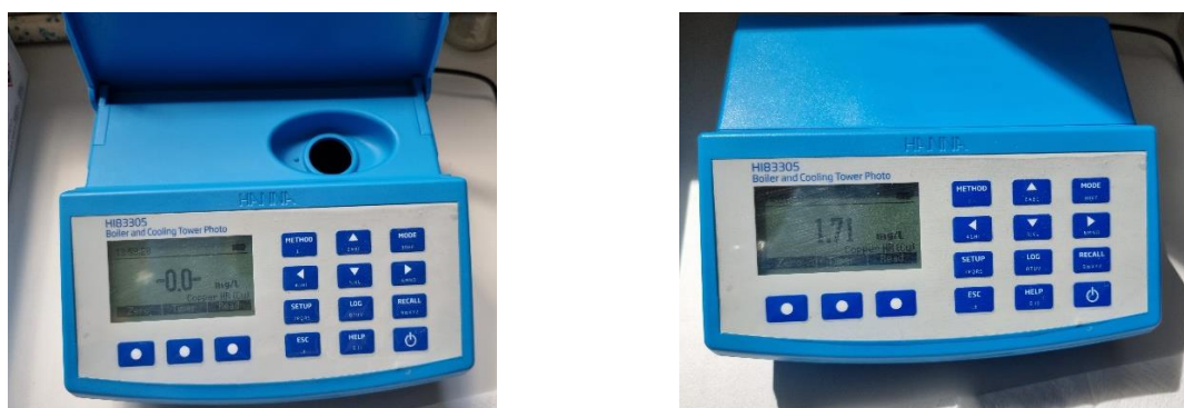
Figura 6. Imagini cu Fotocolorimetru Hanna Instruments-HI83305-01, în diferite stadii de măsurare
