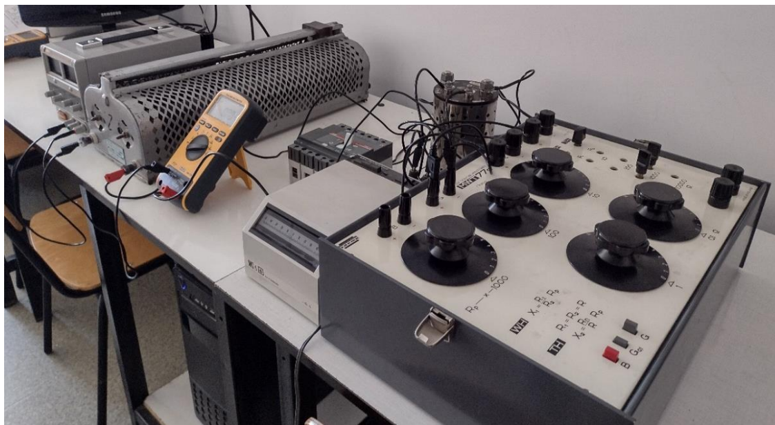
Figura 8. Montaj pentru măsurarea rezistenței de contact cu puntea Thomson
