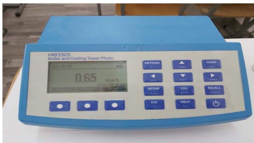
Fig. 8. După cele 3 minute am apăsut tasta READ ,s-a făcut citirea și la final acesta a fost rezultatul, 0,65 mg/l.
