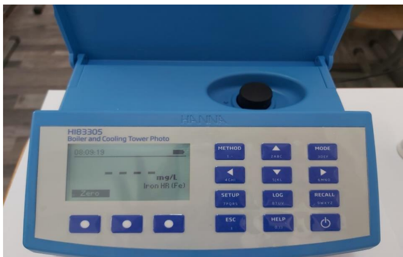
Fig. 4. Am introdus în aparat cuva cu proba de apă(10ml) ștearsă bine pe toate părțile și am apăsat tasta ZERO.
