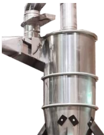
Figura 4.1. Noul model de separator cu clapeta de reglaj a debitului
