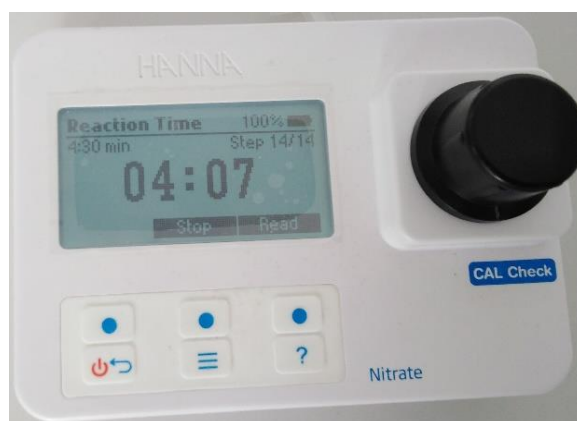
Fig. 3 Unul dintre pașii necesari pentru măsurarea nitraților
