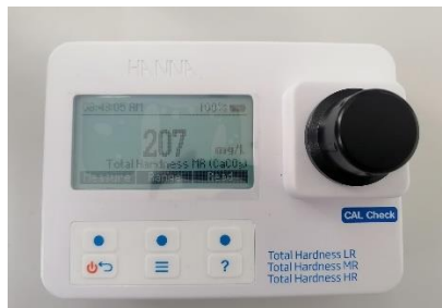
Fig 7. Valoarea obținută în urma experimentului pentru duritatea totală, mg/L de carbon de calciu.
