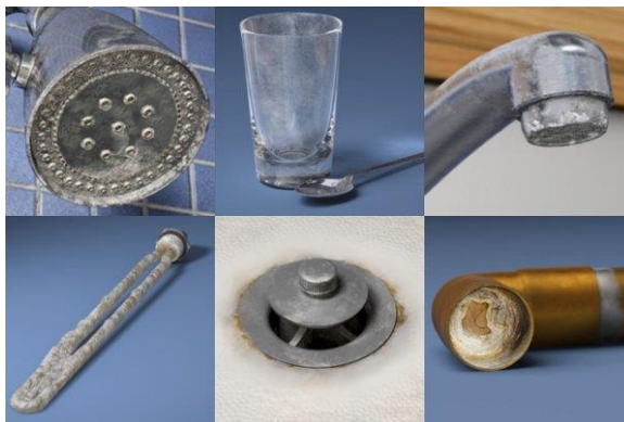
Fig 3. Apa dură indentificată datorită concentrațiilor ridicate de minerale de calciu și magneziu.[6].
