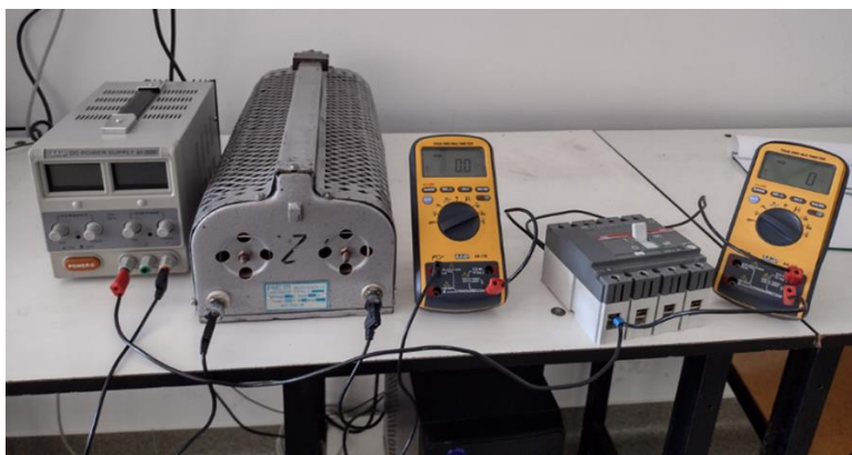
Figura 6. Montajul aval pentru metoda V-A
