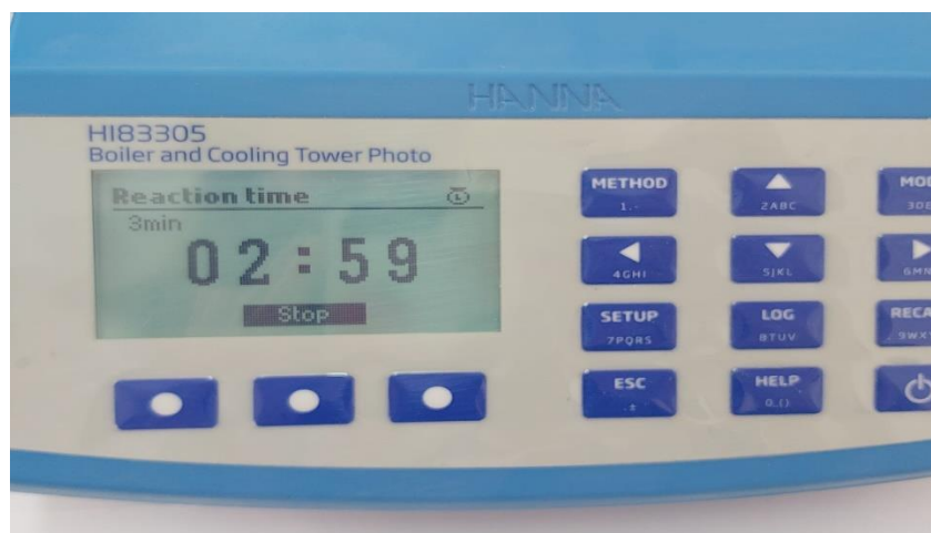
Fig. 7. Am introdus din nou cuva în aparat și am apăsut tasta TIMER
