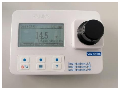
Fig 10. Valoarea obținută în urma experimentului pentru duritatea experimentală în grade engleze.
