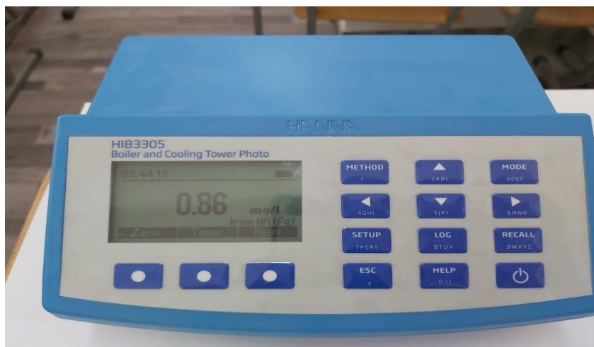
Fig. 9. Acesta este rezultatul pentru a doua probă de apă, 0,86 mg/L Fe.
