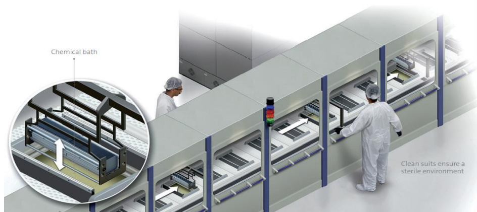
Fig.13 - Tratarea chimică și termică a foilelor de siliciu
