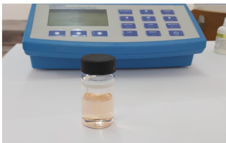
Fig. 6. Am scos cuva din aparat și am adugat un plic de HI93721-0 Fe Domeniu Ridicat Reactiv și am agitat până s-a dizolvat toată pudra.
