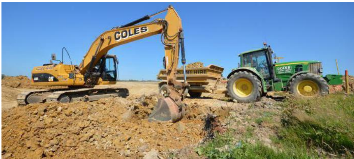
Fig. 1. Exploatarea argilelor cu excavatorul lopată mecanică și transportul cu tractoare cu remorcă (sursa: https://decoratex.biz/bsn/ro/proishojdenie-vidyi-i-dobyicha-glinyi.html )
