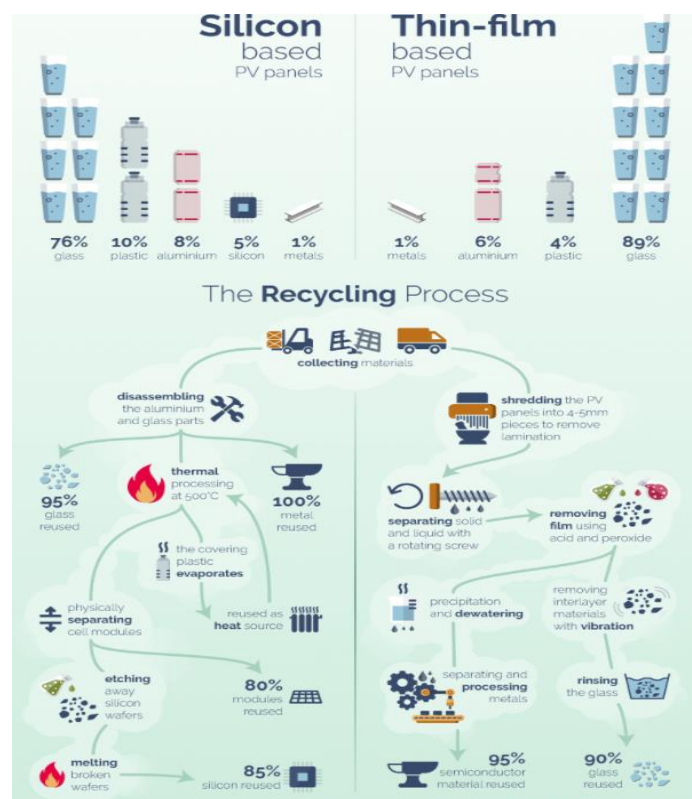
Fig.20 – Procesul de reciclare al panourilor fotovoltaice (mono și policristaline și cele cu peliculă)
