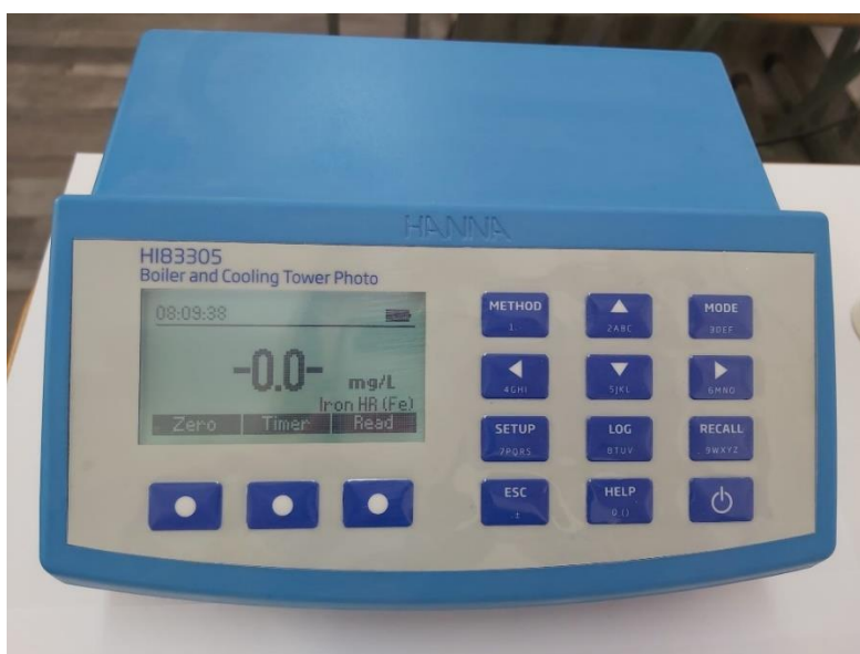
Fig. 5. Aparatul a fost adus la 0, iar din acest moment el este pregătit pentru măsurare.
