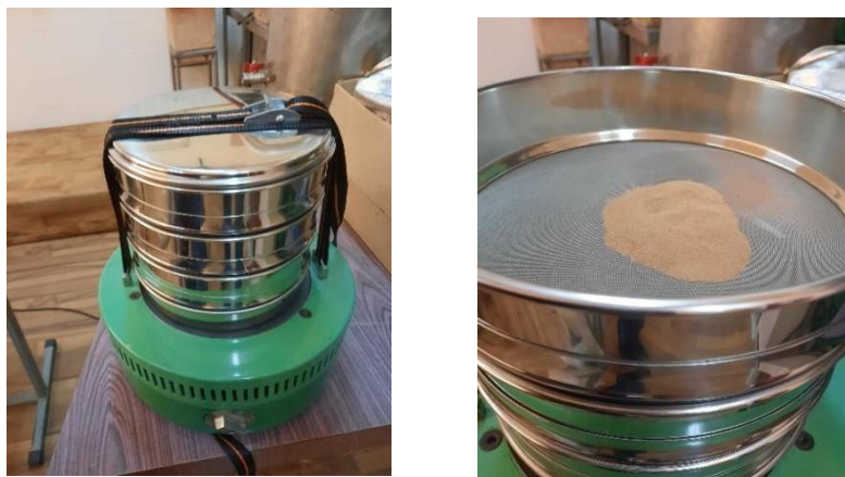
Fig. 2. Site cu sistem de vibrare electromagnetic
