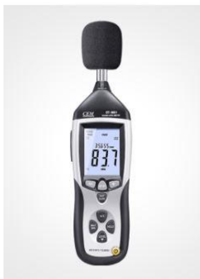
Fig.2 Sonometrul CEM DT-8852 Alcomax
