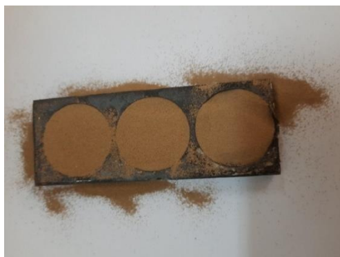
Figura 5. Imagine cu pulberea liber vărsată în forma metalică după nivelată
