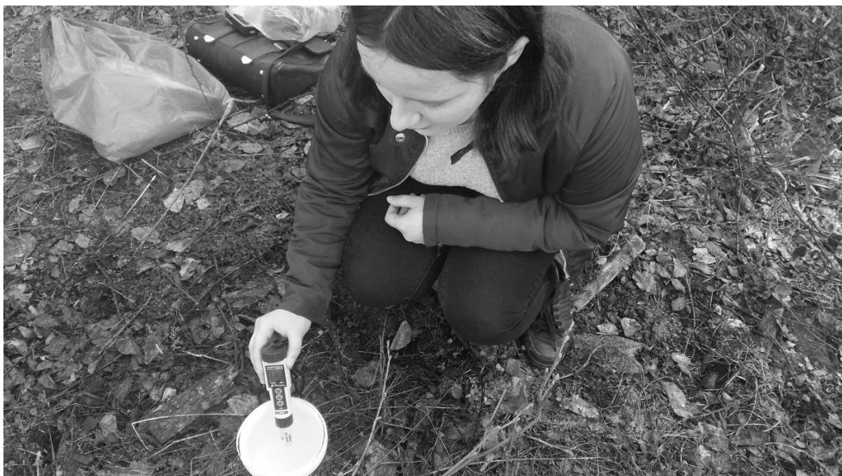
Fig.2.2. Determinarea parametrilor de mai sus cu ajutorul stick-ului Extech, Sursa: arhiva personală
