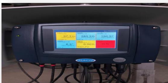
Fig. 2. Aparat cu senzori de măsurare continuă a parametrilor
