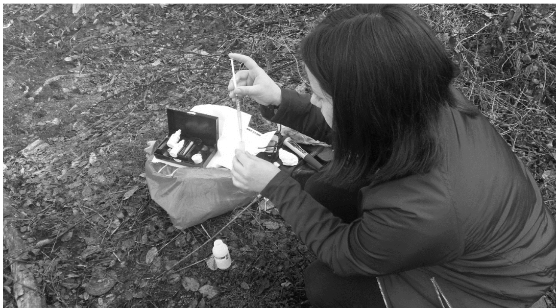
Fig.2.3. Determinarea conținutului de săruri cu ajutorul kit-ului “Hanna Instruments – Salinity Test Kit”. Sursa: arhiva personală
