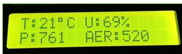
Fig. 5. Afișare valori măsurate: temperatură, umiditate relativă, presiune atmosferică, grad de poluare a aerului (ppm)
