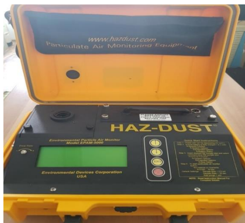
Fig.2. Monitorul de particule HAZ-DUST EPAM 5000
