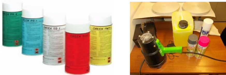
Fig. 4 Set de lichide penetrante și lampa fluorescentă (Sursa: UAC Europe SRL).
