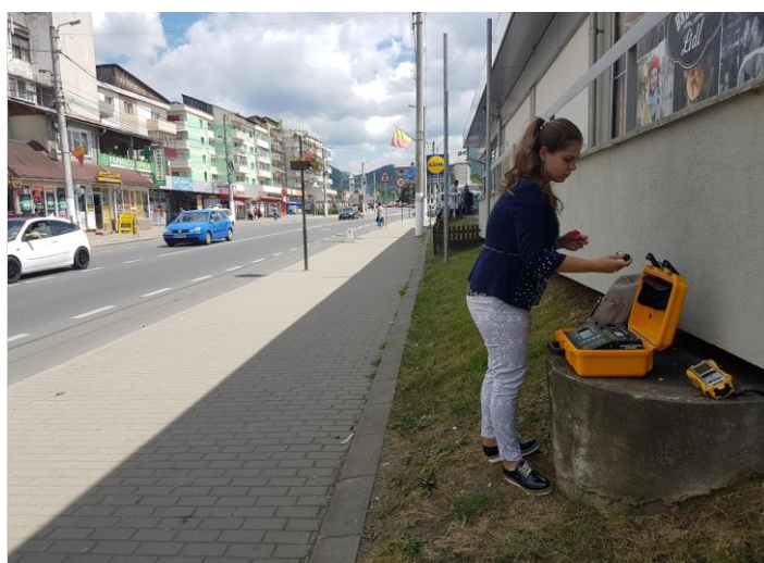
Fig.5. Masuratori realizate cu aparatul de particule material in suspensie, HAZ-DUST
