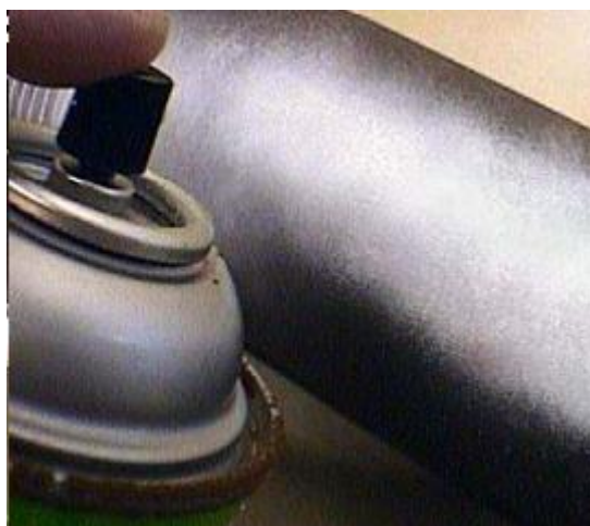
Fig. 7 Aplicarea lichidului penetrant .
