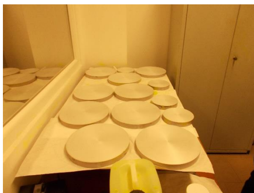
Fig. 6 Prepararea suprafeței probelor din bare turnate (Sursa: UAC Europe SRL).
