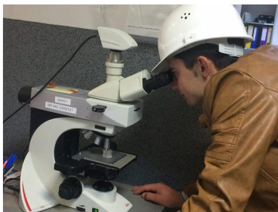
Fig. 11 Examinarea suprafețelor la microscopul optic Leica 2500M (Sursa: UAC Europe SRL).
