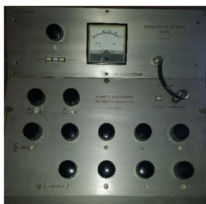
Fig.3.5. Schema măsurare cu puntea Schering (PSBI-A72).
