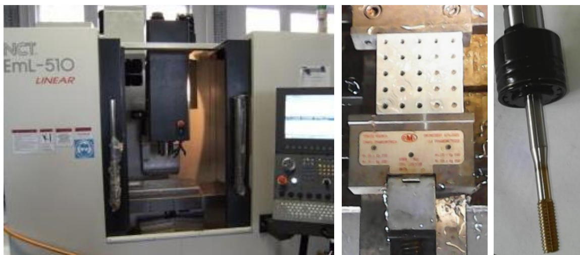
Fig. 1. Elementele ansamblului tehnologic utilizate în cadrul prelucrării filetelor
