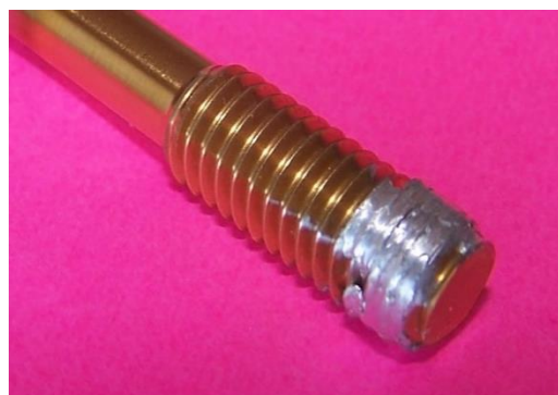
Fig. 3.b. Tarod formare fără canal de ungere
