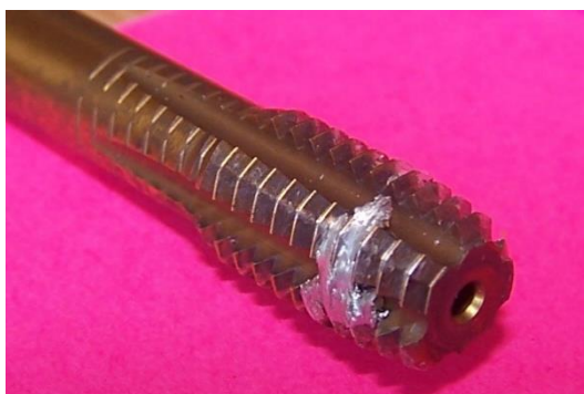
Fig. 3.a. Tarod formare cu canal de ungere
