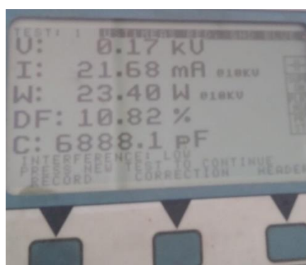
Fig.3.10.Ecranul trusei Avo după încercarea cu tensiune alternativă a motorului electric.
