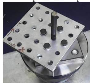
Fig. 2.c. Epruveta și metoda de prindere a acesteia
