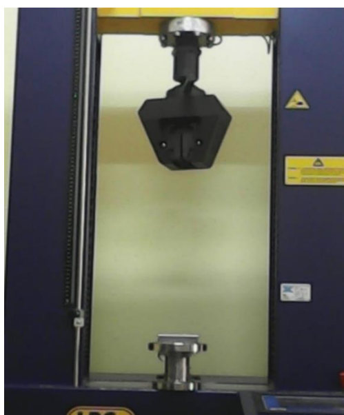
Fig. 2.a. Mașina de testat universală cu dispozitiv de prindere
