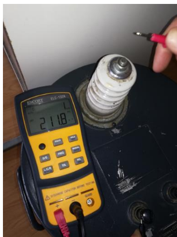
Fig.3.12. Măsurarea capacității condensatorului considerat etalon.
