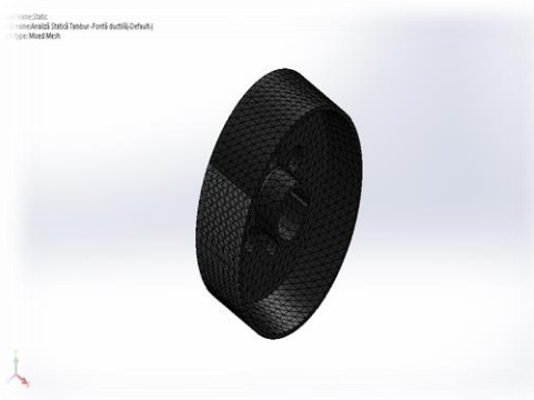
Fig.4 Realizarea plasei de noduri
