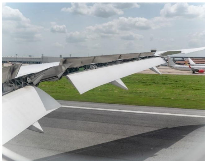
Fig.2.2. Piesa placă de închidere montată la flapsuri [3].
