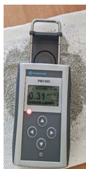
Fig.7. Măsurarea radiațiilor din zeolitul din Rupea, valorile au depășit 0,3 \mu\text{Sv/h} astfel s-a aprins alarma (Sursă: arhivă personală).
