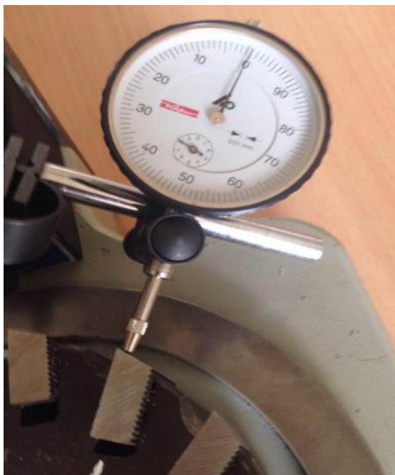
Fig.3 a) Controlul batai radiale
