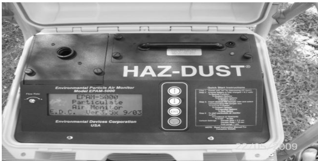
Fig. 7. Aparat de monitorizare a pulberilor model EPAM - 5000
