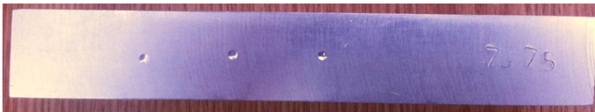
Fig.3.4. Măsurarea durtății Brinell (HBW 10/500,) în 3 puncte pe semifabricat.
